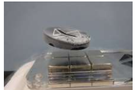
超伝導体が磁気浮上している様子
